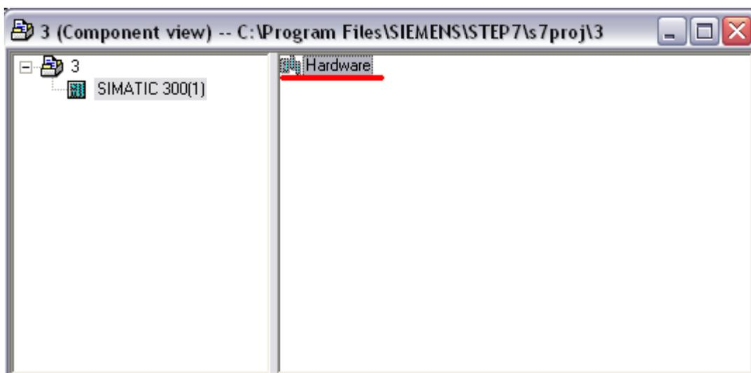
Добавляем новую рейку 300 с помощью пункта меню (или нажатием правой кнопкой мыши на пустом поле конфигурации) InsertObject ->Simatic 300 ->Rack 300 ->Rail
