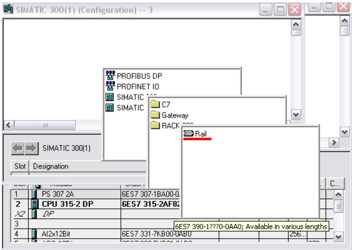
В библиотеке HardwareCatalog устанавливаем на рейку требуемые модули:
