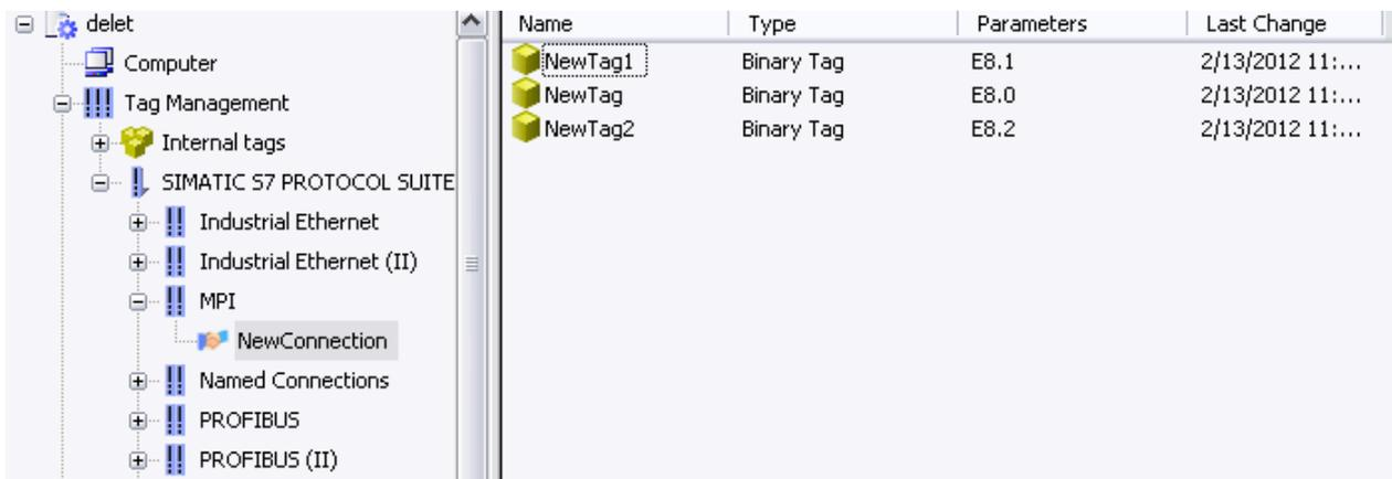
Адресация соответственно DI 8.0-8.2, что соответствует физическому адресу входного параметра ПЛК. Для этого ЛКМ дважды клацаем по тегу и в поле Address нажимаем кнопку Select.
